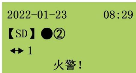
图十二：火警时 LCD 的显示页面
